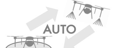
飛行停止または設定速度以下になると、散布が自動的に停止。送信機の散布スイッチを手動でオンオフする切替操作が不要に。
